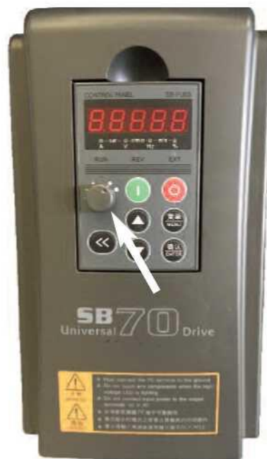
Fig.7.2 Detaliu potențiomtru pentru reglarea turației motorului
